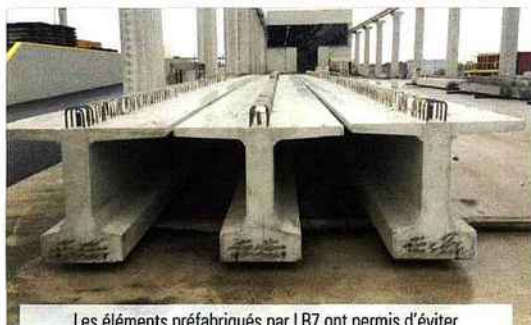
Les éléments préfabriqués par LB7 ont permis d'éviter de nombreux "coups de grue".
